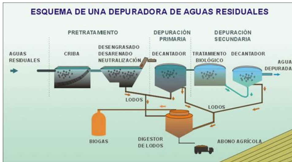
Fig. 36: Depuradora de aguas residuales y obtención de abono
