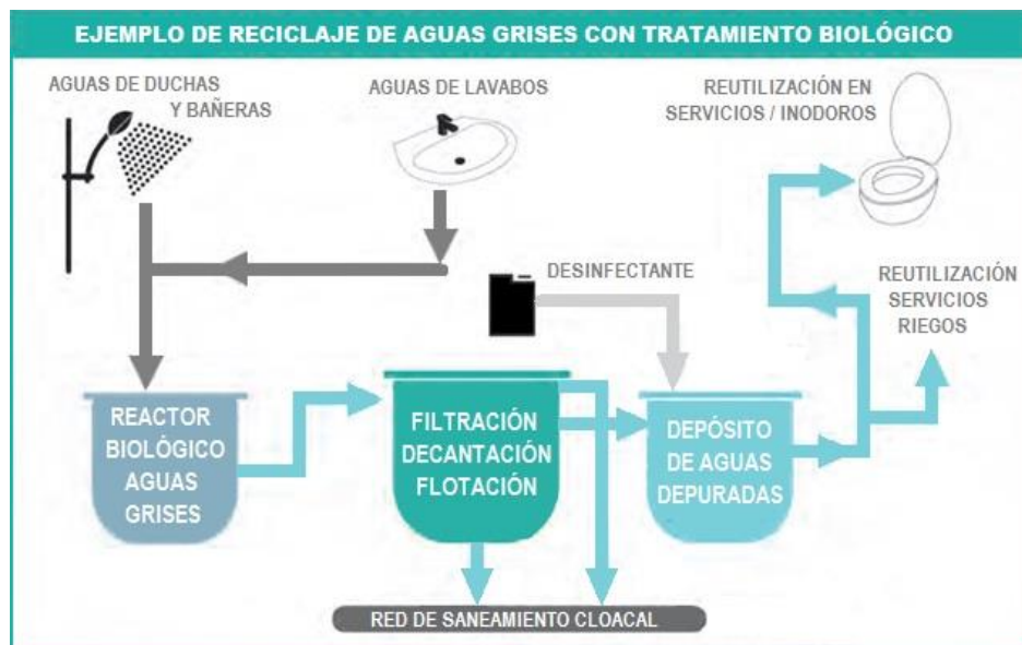
Fig. 35: Esquema clásico de reciclaje de aguas grises
