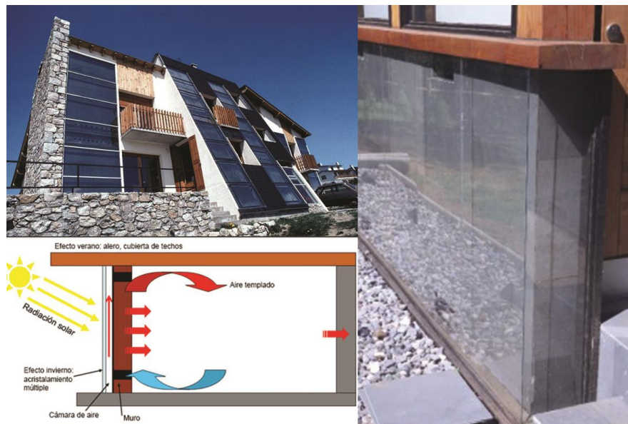
Fig. 72: Muro trombe, sistemas de lecho de piedra, acumulación de calor por materiales con inercia térmica.
